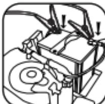
c. Daraufhin blinkt die grüne Kontrollleuchte auf dem Interface. Die Spannungen des Starthilfegeräts und der Autobatterie werden angezeigt und das Gerät befindet sich im Starthilfemodus. Falls die Spannung der Autobatterie ausgelesen werden soll, drücken Sie den An-/Ausschalte, um den Starthilfemodus zu verlassen und in den Messmodus zu gelangen. Die grüne Kontrollleuchte erlischt und überprüft, ob die Autobatterie in Ordnung ist. Sie Anzeige zeigt nur die Spannung der Autobatterie an.
