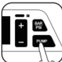
c. Drücken Sie die -Taste, um die Einheit des Reifendrucks zu ändern (BAR/PSI).
